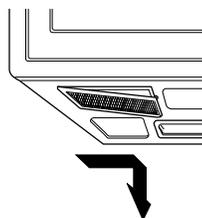
2. Laver dans le lave-vaisselle ou faire tremper les filtres à graisses dans de l'eau chaude additionnée d'un détergent doux. **Ne pas utiliser d'ammoniaque. L'aluminium ternira filtre.**
