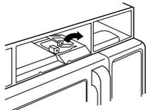
6. Remplacez avec une ampoule pour appareils électroménagers de 30 ou 40 watts.
