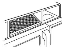
6. Glissez le fond du couvercle de ventilation en place. Poussez sur le dessus jusqu'à ce qu'il soit solidement en place. Vissez les vis de montage. Remettez la tension de la source d'alimentation principale en circuit.
