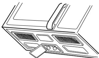
3. Dévissez l'ampoule (ou les ampoules) brûlée(s) et remplacez-la (les) avec une (des) ampoule(s) de 30 ou 40 watts.
